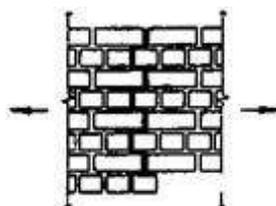
Рисунок 2 - Растяжение кладки по перевязанному сечению
