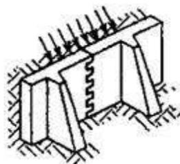
Рисунок 3 - Растяжение кладки при изгибе по перевязанному сечению
