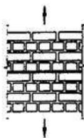
**Рисунок 1 - Растяжение кладки по неперевязанному сечению**
